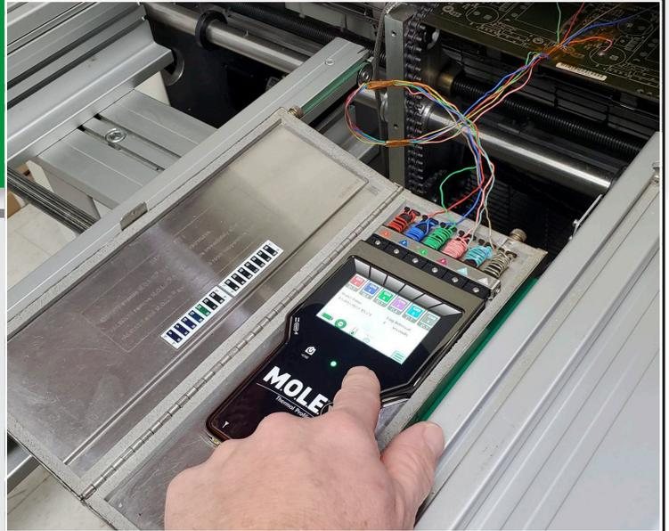
凭借革命性的新设计，M.O.L.E.™ EV6为温度曲线测量仪带来了深度数据采集和触摸屏便利使用。可携式温度曲线测量仪可在设备上进行配置、测量和数据分析-提供即时可操作的信息，节省时间并减少对操作员密集培训的要求。电容式触摸屏犹如使用智能手机，用户现在可以在指尖上便获得车间数据。六通道M.O.L.E.™ EV6可用于所有ECD RIDER™ 机器质量管理技术工具，并提供了一种真正可扩展的方法，通过视觉、触摸屏控制更容易实现。
